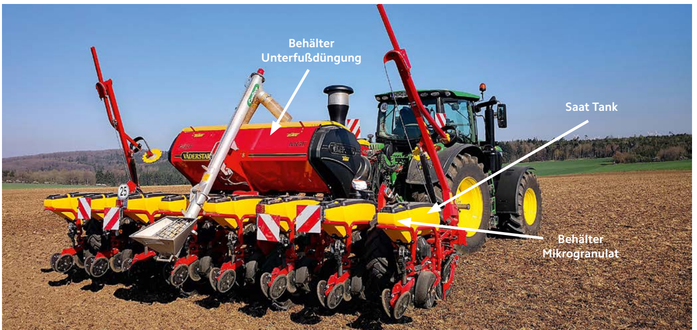
Väderstad Tempo F Einzelkornsämaschine mit Mikrogranulatstreuer
